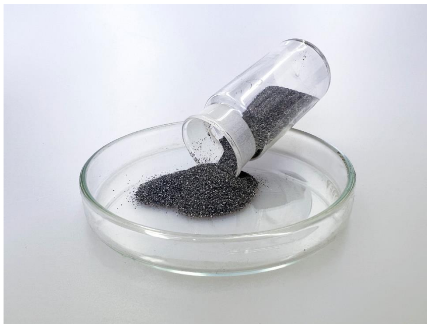
Катализатор окисления аммиака на основе платины и оксида титана
